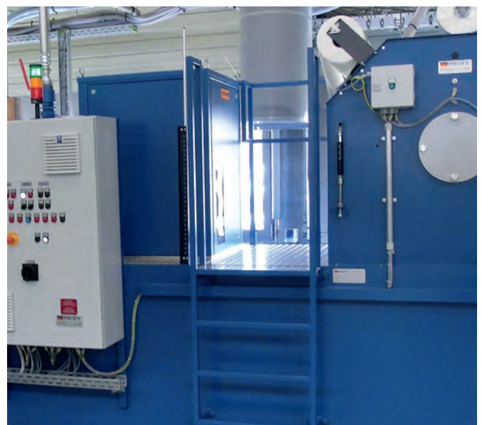
Refroidisseur par immersion pour huile de rectification
