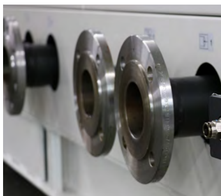
Détail installation de thermorégulation à 6 circuits
