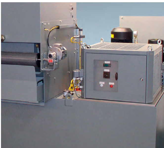
Refroidisseur par immersion pour émulsion de fraisage
