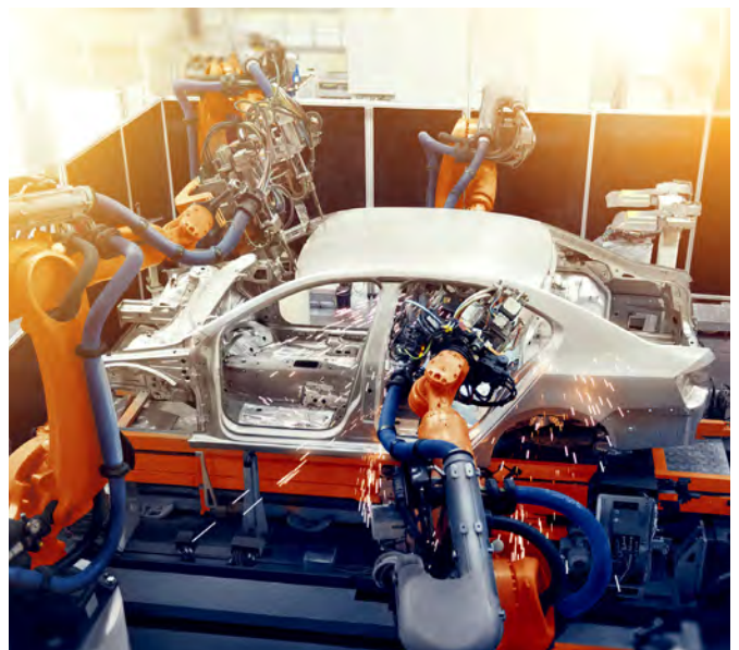
Soudage robotisé dans la production automobile
