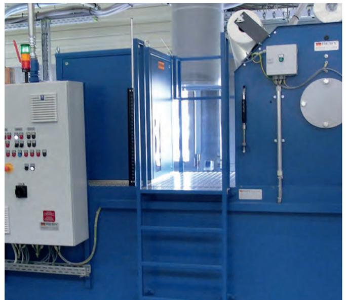
Eintauchkühler für Öl für Schleifbearbeitung
