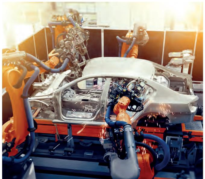
Roboterschweißen in der Automobilproduktion
